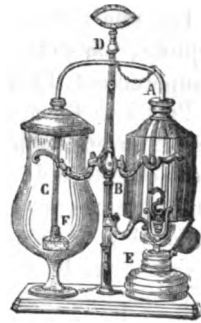
FIG. 18. — Cafetière à vis et à bascule.—A, Tube de communication.—B, Vase en porcelaine où l'eau entre en ébullition.—C, Vase en verre où se trouve le café pulvérisé.—D, Pied support.—E, Lampe à alcool.—F, Filtre.
